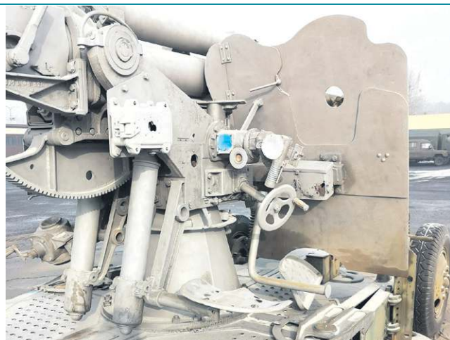
Elementy poddane piaskowaniu czekają na nową warstwę farby
