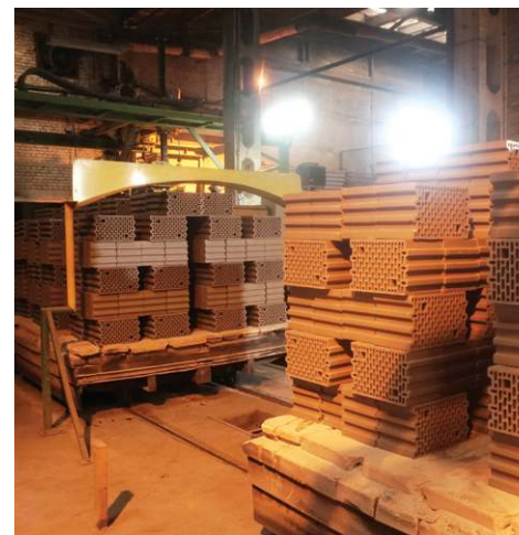
Wysuszone cegły w kolejce do wypalania
